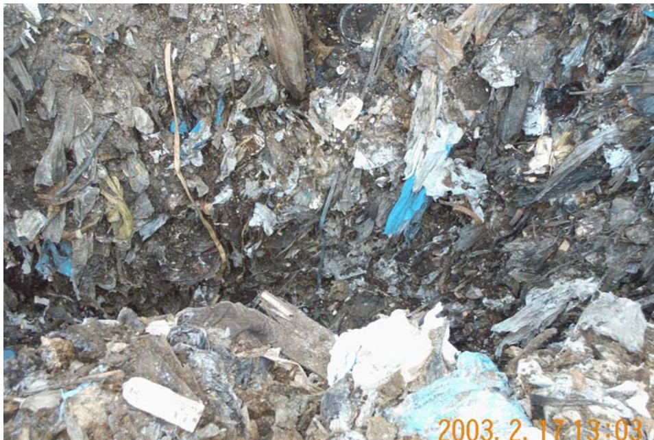
Figur 64. Foto taget ner i hålet som grävts ut ner till 9 meters djup intill hål 15. Lite klumpar av injekterat askmaterial följde med i grävskopan.
