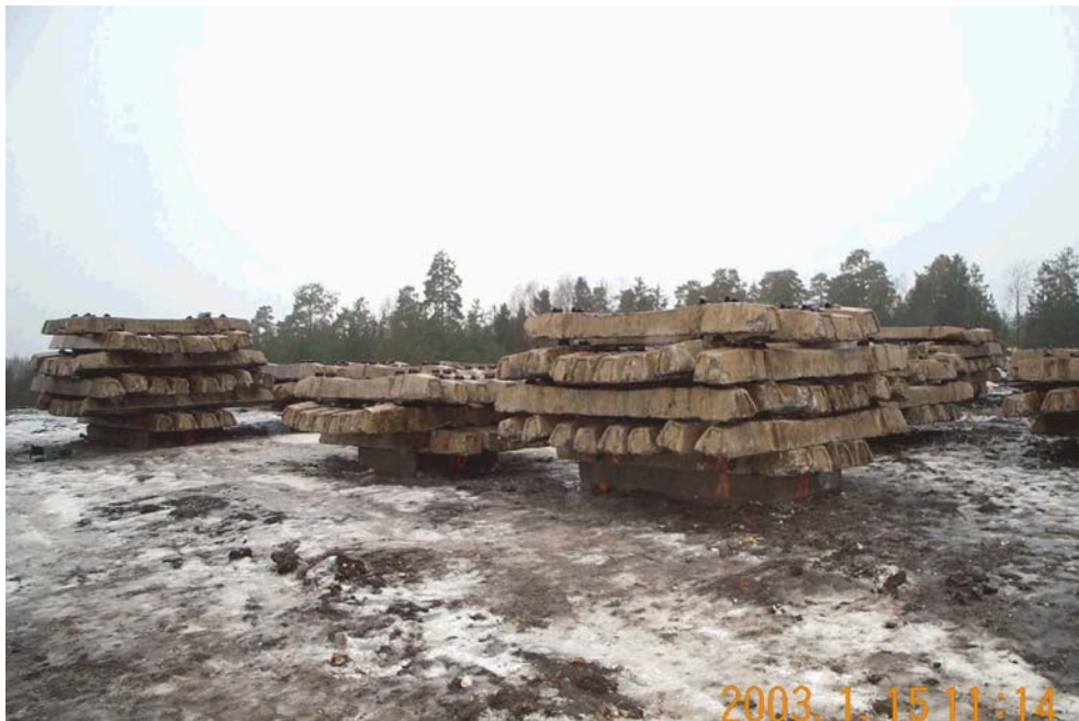
Figur 7. Sättningsmätningar. 1 m 2 stora betongplattor med en belastning på cirka 4,5 ton.
