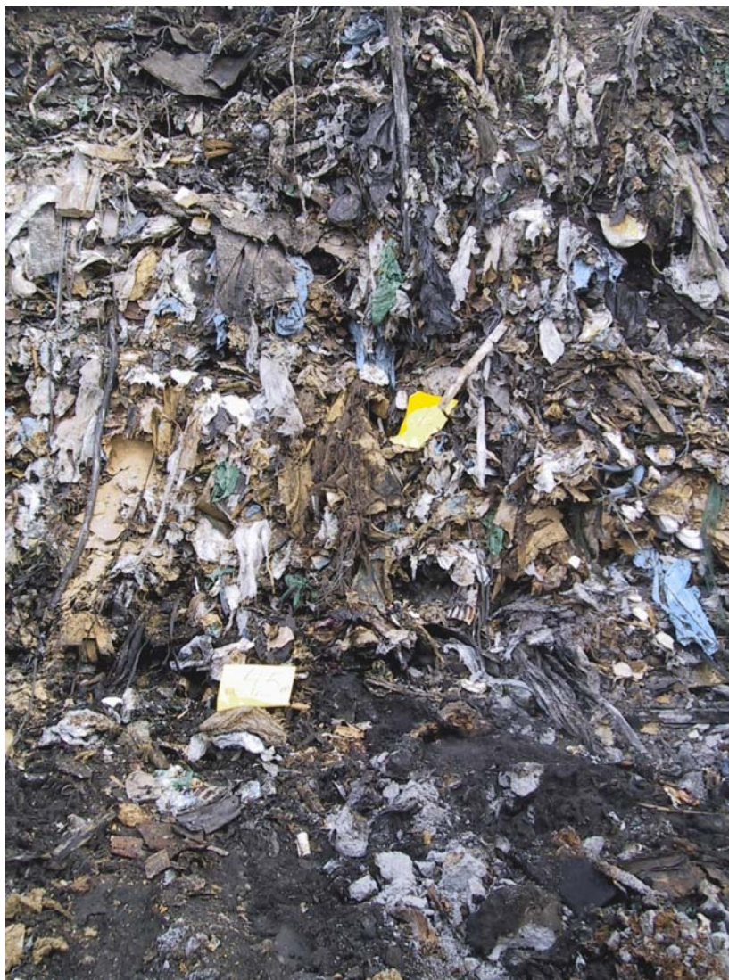
Figur 59. Klumpar av stelnad injekterad aska vid 4,5 meters djup framför hål 4. Materialet i väggen består främst av industriavfall med en del gips.
