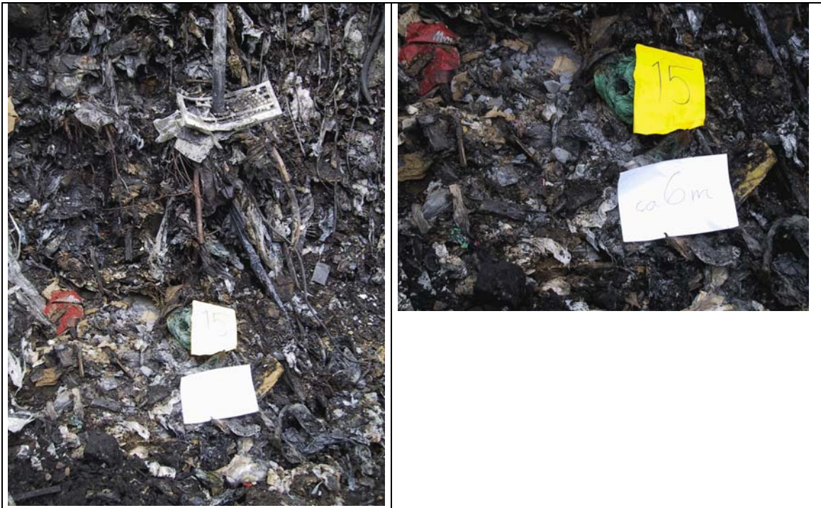
Figur 62. Klumpar av stelnad aska intill hål 15 vid 6 meters djup.
