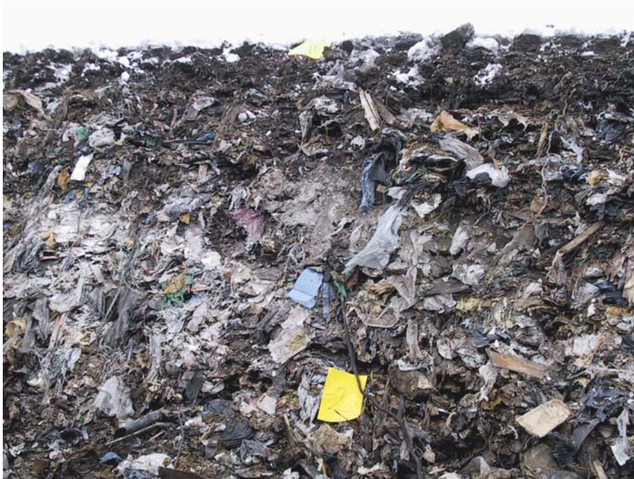
Figur 56. Vertikal vägg cirka 2 meter från hål 3 och 15. Materialet består mestadels av industriavfall med en hel del gipsskivor i.
