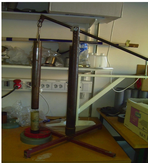
Figur 3.2. På bilderna visas stången med räfflad ändyta som användes vid packning av proverna (Lenströmer 2002).
