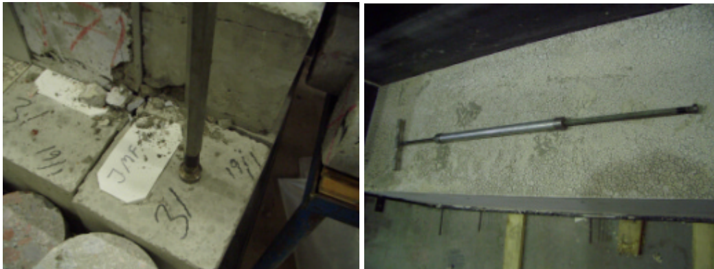
Figur 8. Beskrivning av TSK-utrustning, utförande (t.v.) samt utseende (t.h.)
