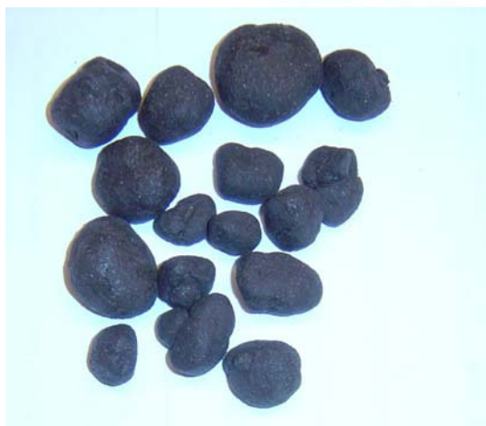
Figur 21. De tillverkade pelletsen av aska från Motala. Högst upp, pellets utan överdrag, nederst till vänster, pellets överdragna med vattenglas, nederst till höger, pellets överdragna med silika.
