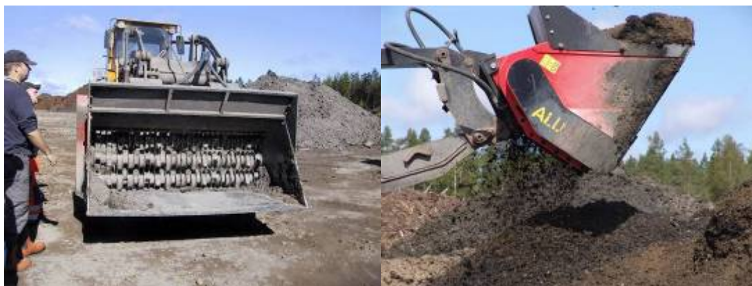
Figur 2.7 Förblandning av flygaska och avloppsslam med rotorskopa..
