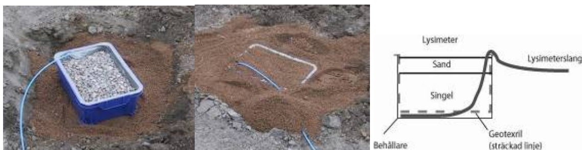
Figur 2.12 Lysimeterinstallation och utformning.
