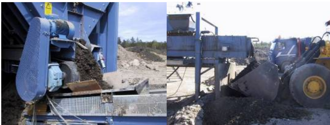
Figur 2.8 Utmatning av förblandat FSA (vänster bild) och färdig FSA blandning från skrubblandaren (höger bild)..
