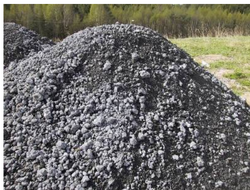
Figur 2.10 Dräneringsmaterial, bestående av slaggrus (Söder Energi)
