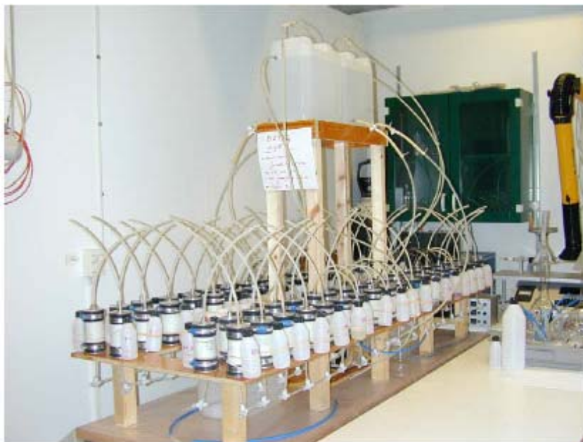
Figur 9. Bild på försökupställningen med 72 kolonnpermeametrar.
