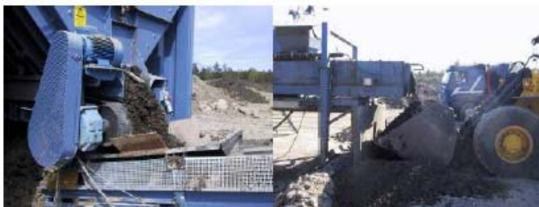
Figur 7. Matning av förblandat material (vänster bild.) och färdig blandning från skruvblandaren (höger bild) [5].
