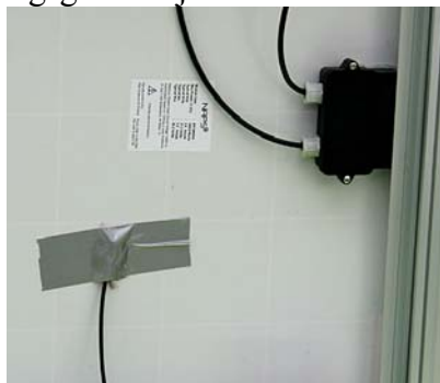
Figur 3.12 Temperaturgivare på undersidan av en solcellsmodul (under den grå tejp).
