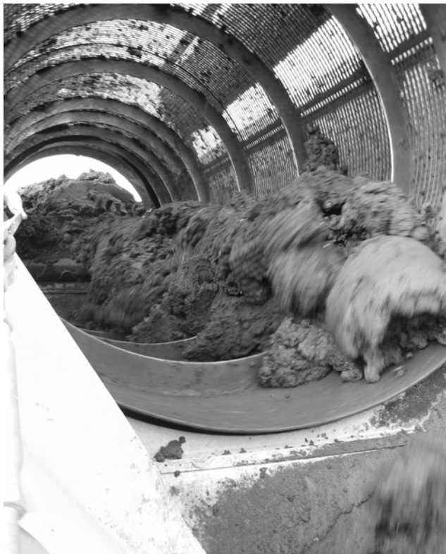
Figur 4-9. Omblandning och utmatning från trumsikt vid Renova.
