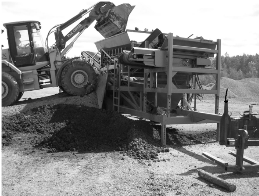
Figur 4-6. Blandning av aska och slam i stjärnsikt vid SRV Återvinning.
