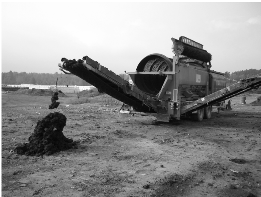
Figur 4-8. Vid Renova användes en trumsikt för blandning av slam och aska.
