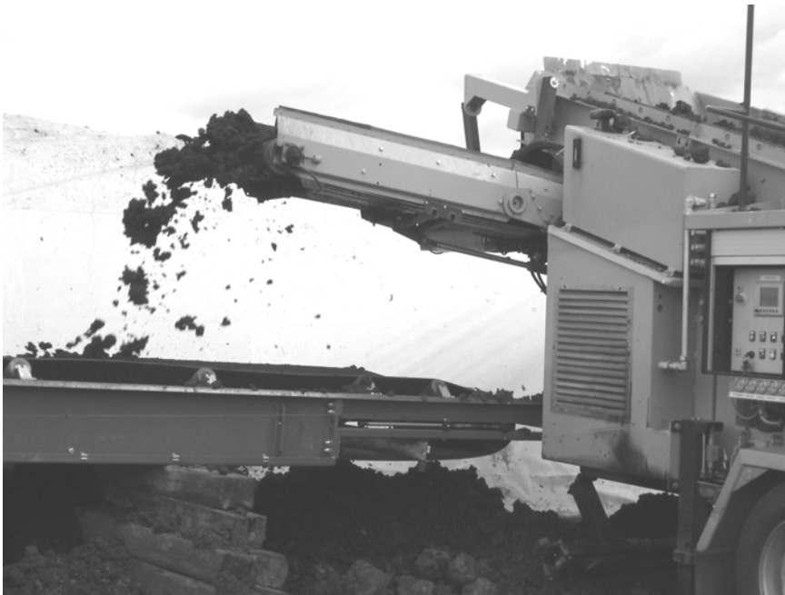
Figur 4-3. Utmatning av slam från stjärnsikten till transportbandet.
