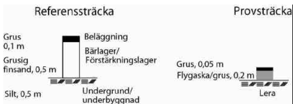
Figur 3.24 Referens- och provsträckans uppbyggnad, Börje.
