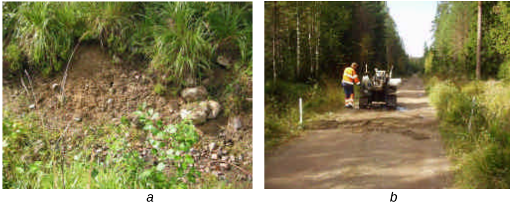
Figur 3.2 (a) Markytan består av en siltig sandig morän, (b) Skruvprovtagning av markprofilen och installation av grundvattenrör, Gv 10 (vänster) Gv3 (höger).
