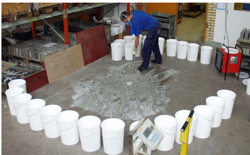
Figur 5. Neddelning av prov vid SP med hjälp av fraktioneringsskyffling
