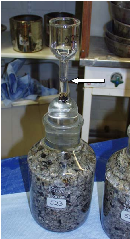
Figur 23. Pyknometer fylld med bottenaska 4-31,5 och vatten. Den vita pilen markerar den rits upp till vilken vatten fylls på.
