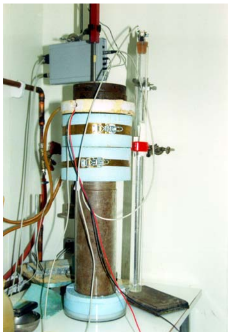
Figur 34. Frysutrustningen vid VTI för att prova tjällyftningsegenskaper
