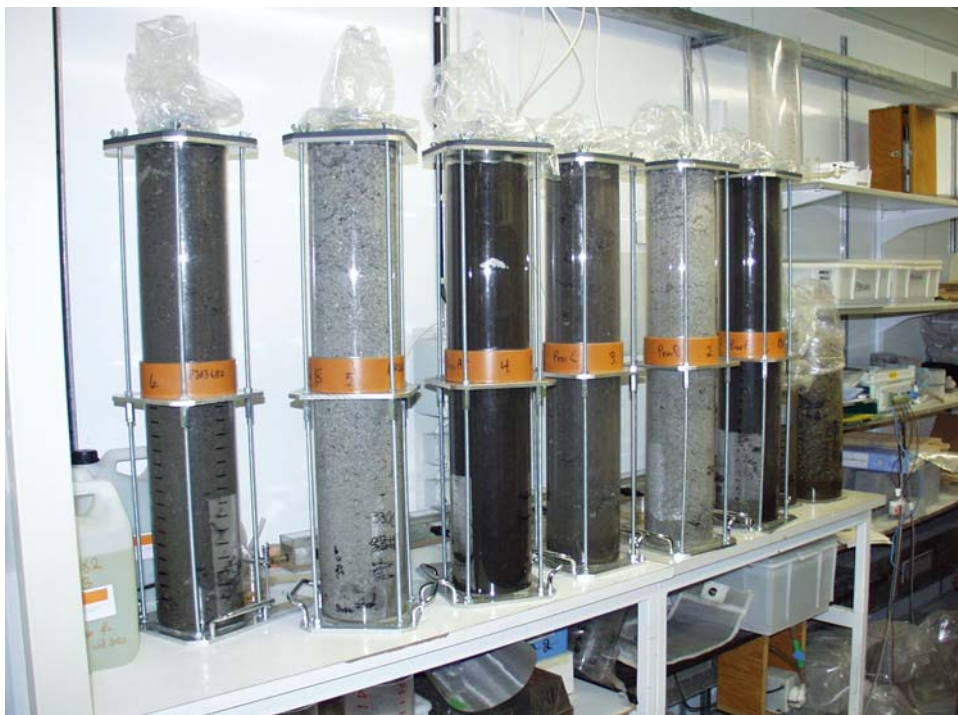
Figur 8. Kolonner för provning av kapillär höjd
