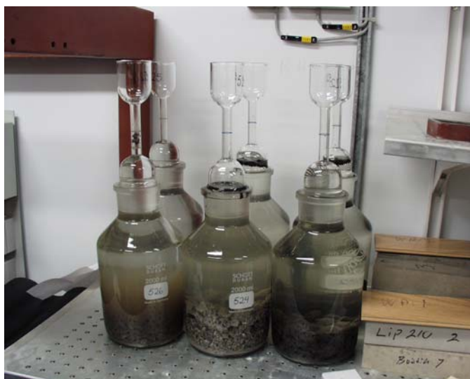
Figur 7. En av de använda testmetoderna för vattenabsorption var långtidsprovning med pyknometrar
