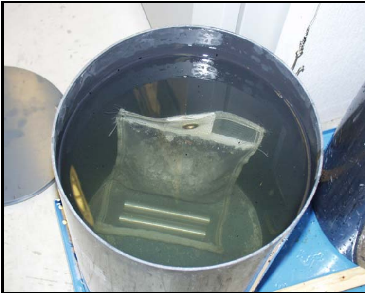
Figur 24. En semipermeabel påse fylld med bottenaska för provning av vattenabsorption.
