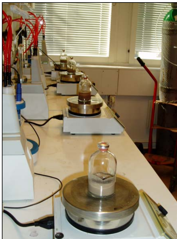
Figur 3. Gasbildning under magnetomrörning. Fyra parallella försök.
