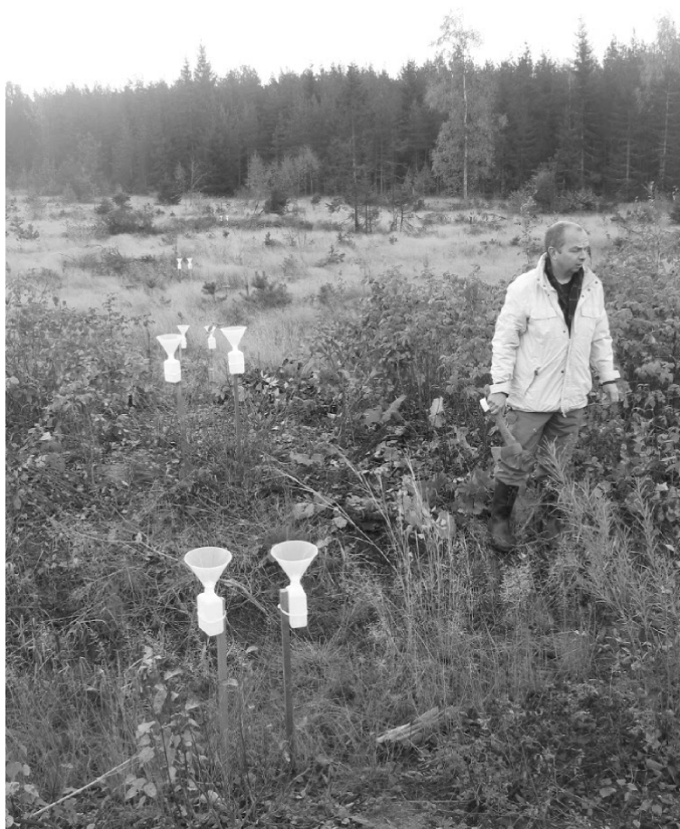
Figur 3. Trattar och flaskor för insamling av dammdeposition.
