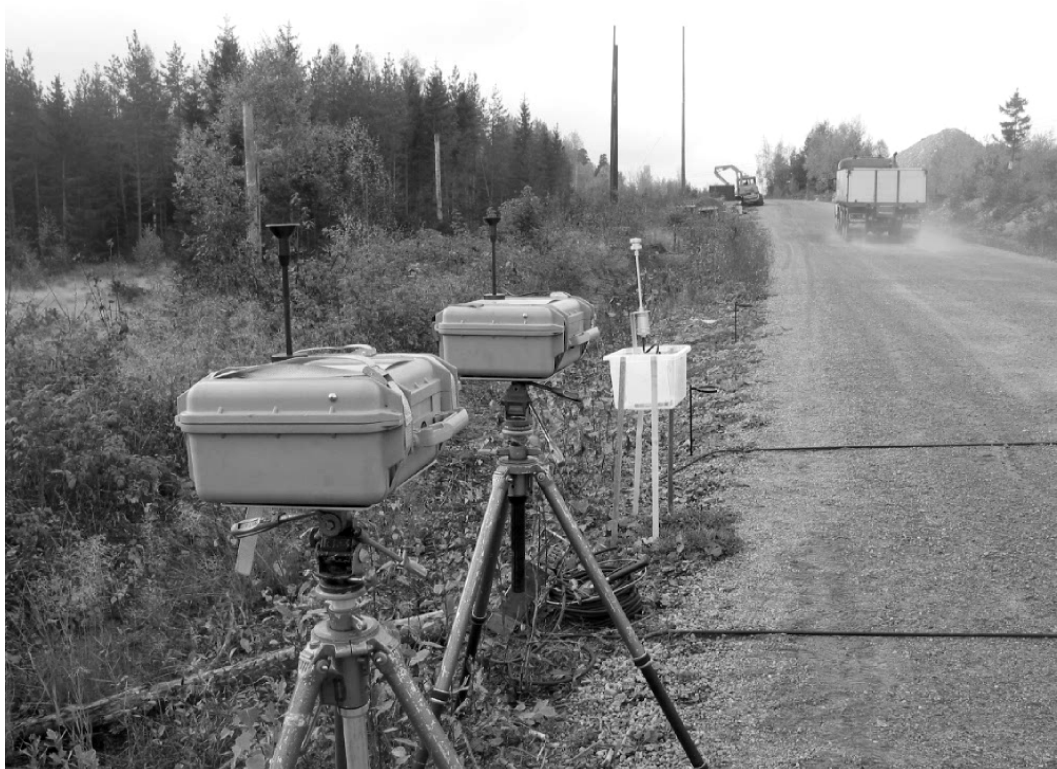
Figur 4. Två DustTrak för mätning av partikelhalter ( PM_{10} och PM_{2,5} ) och Mini Partisol för insamling av PM_{10} på filter. Trafikräkneslangarna kan även ses tvärs över vägen.
