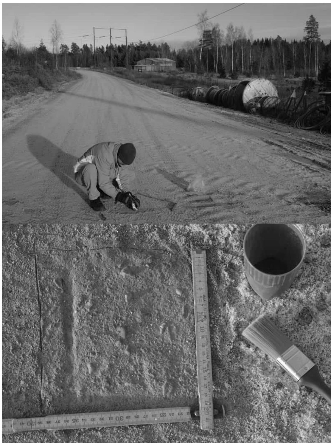
Figur 2. Provtagning av grusslittlager ovan bärlager av aska 26 november, 2005 - provtagningsomgång 2.
