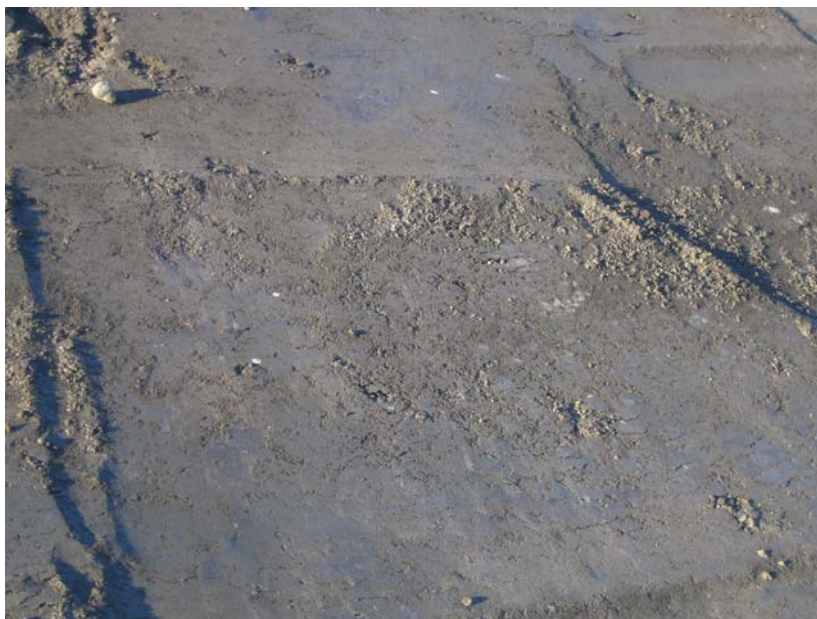
Figur 4. Bilden visar hur askan har börjat ombildas på ytan genom en hård krusta. Omvandlingen sker med den naturliga fukthalt som finns i askan (karbonatisering).
