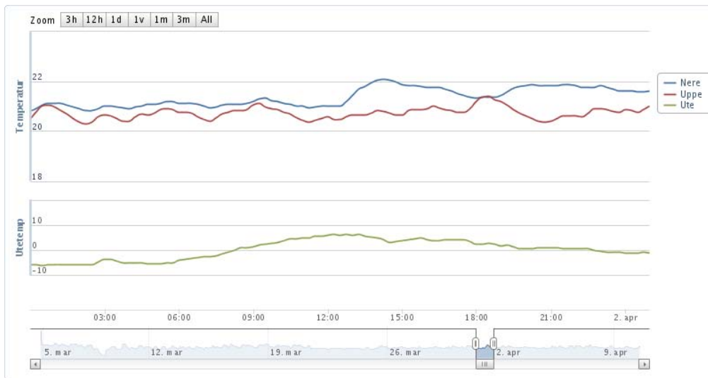
Fig. 38: Inomhustemperaturer i ett av husen under laststyrning
