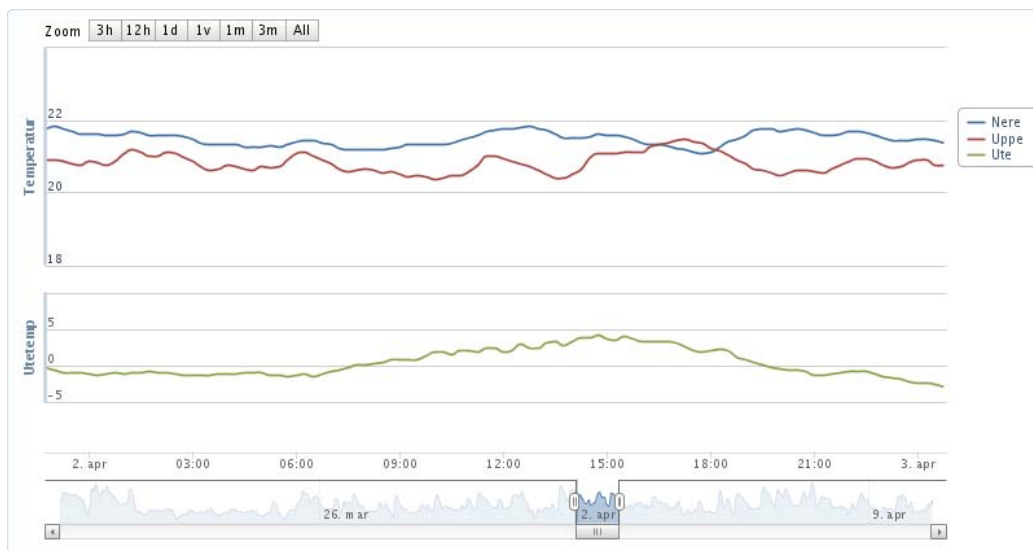
Fig. 40: Inomhustemperaturer i ett av husen under laststyrning
