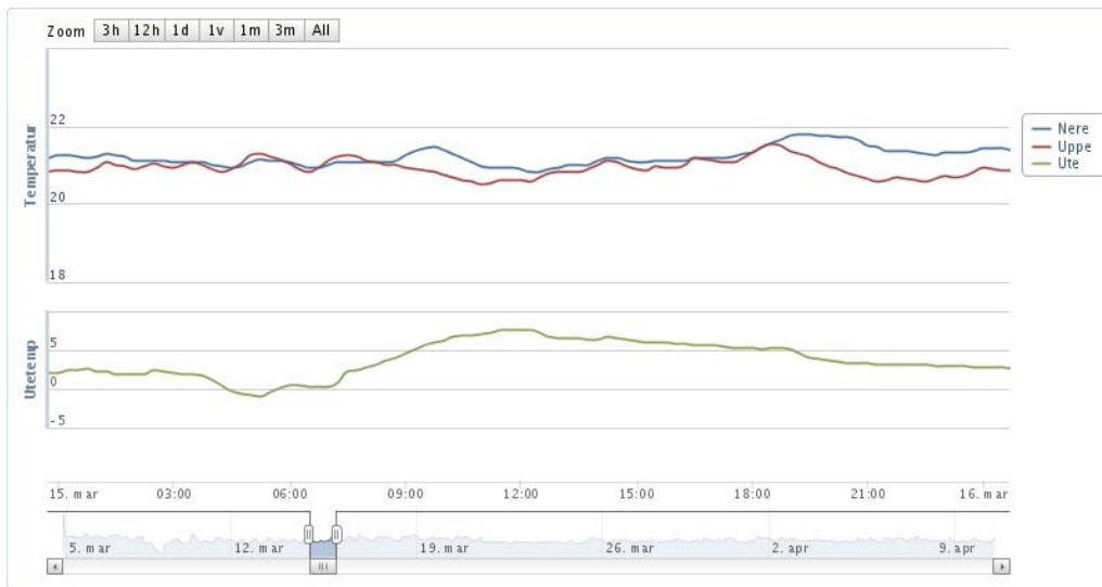
Fig. 34: Inomhustemperaturer i ett av husen under laststyrning
