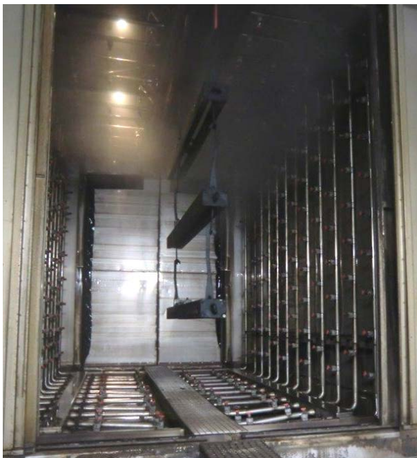
Figur 14. Första avfettningssteget i förbehandlingen. Dysorna duschar detaljerna med avfettningsmedel som värms m.h.a. fjärrvärme. Källa: Toyota Material Handling Europe.
