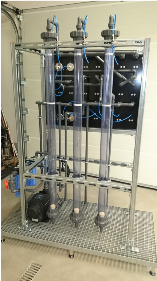
Figur 9. Pilottriggen utan jonbytare
