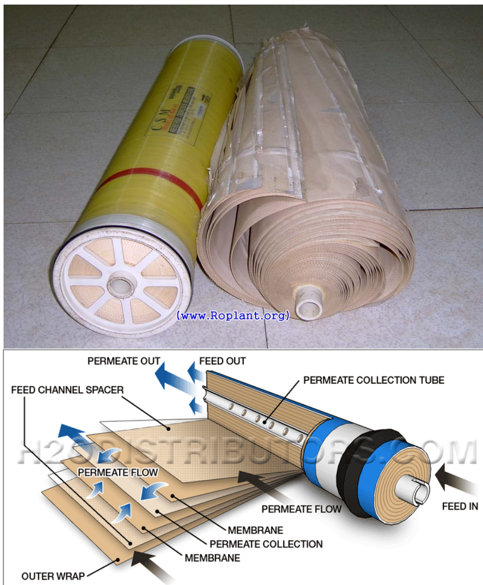
Figur 133. Principiell uppbyggnad av ett spirallindat membran
