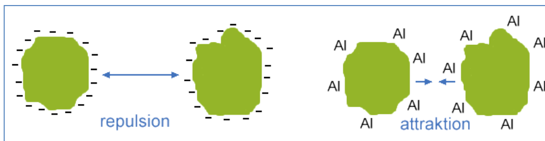
Figur 116. Laddningsneutralisation genom tillsats av ett metallsalt ( Al^{3+} )
