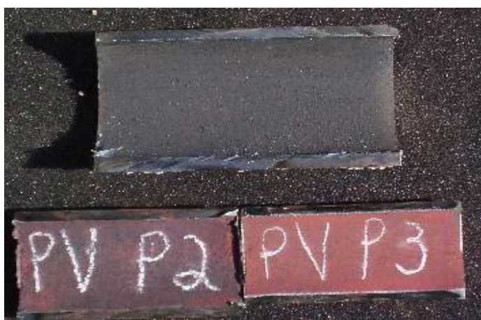
Figur 206. Exempel på olika färgnyanser på oxidskikt i eldstadstuber
