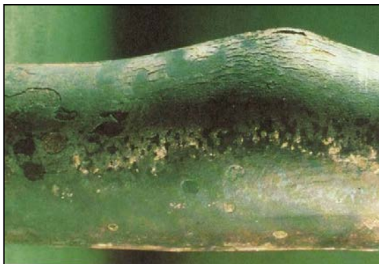
Figur 62. Ansvälld tub som legat med överhettning under lång tid.
