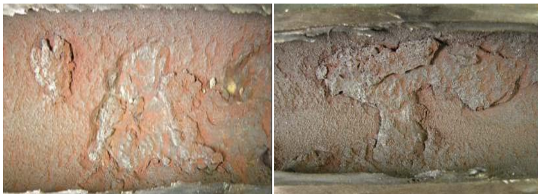
Figur 72. Insidor på renborstade tuber som skadats.
