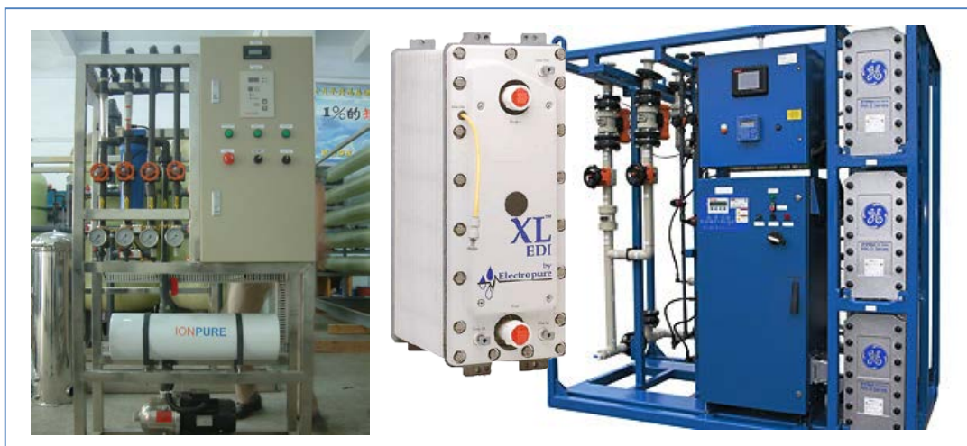
Figur 141. EDI:er från tre olika tillverkare
