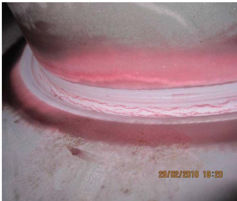
Figur 93. Omfattande spänningskorrosionssprickor i radieövergången mellan axel och turbinskiva
