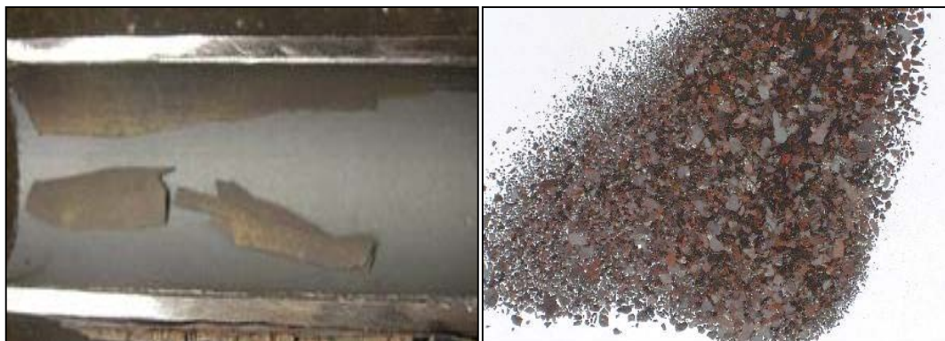
Figur 44. Avskalade oxidskikt i en överhettartub.
