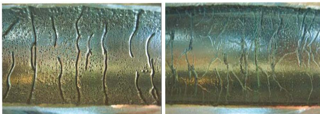
Figur 45. Exempel på djupa (0,6 mm) oxidationsränder i metallen under tjocka magnetitskikt i ÖH-tuber.
