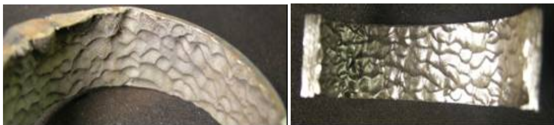
Figur 54. Vågmönster i tubböjar som skadats av erosion
