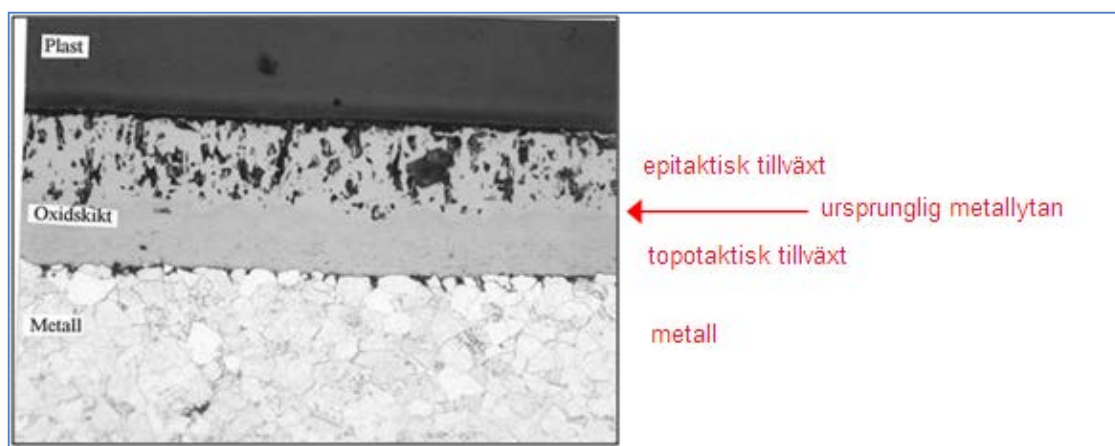
Figur 43. Tvärsnitt av oxidskikt i en överhettartub.
