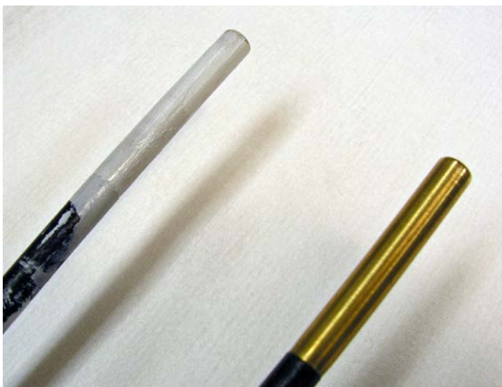
Figur 11. Två av testets givare. En med värmeledande pasta och en utan.
