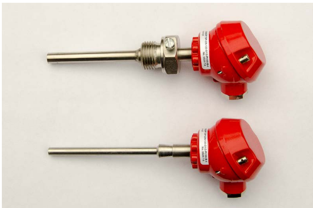
Figur 3. Givare Limatherm med och utan 85 mm dyrkrör
