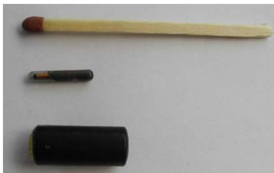
Figur 7. Foto av olika märken som använts i projektet. PIT-tag (mitten) som är 2,1 x 12,5 mm långt och väger 0,12 g, akustiskt märke (nedre) som är 7,3 x 18 mm och väger 1,9 g. Foto Anders Alanärä.
