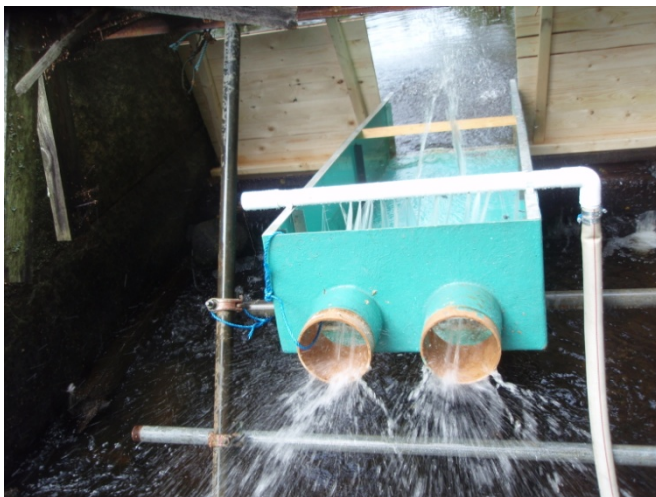
Figur 6 Försöksuppställning med inflöde av vattenfördelat på tre punkter: ett delflöde som spray framför entrén till rännan, huvudflödet till rännans högsta punkt som rinner bortåt i bild och ett delflöde som attraherande ridå framför exitpunkten.
