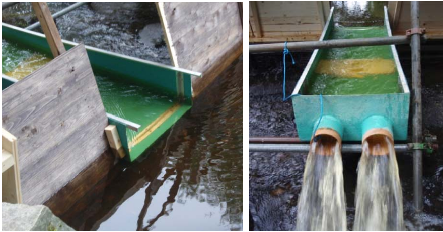
Figur 5 Ränna med utflöde, (a) inlopp med flödet i riktning åt vänster i bild, (b) utloppet i den nedre änden av rännan i nedströms riktning.
