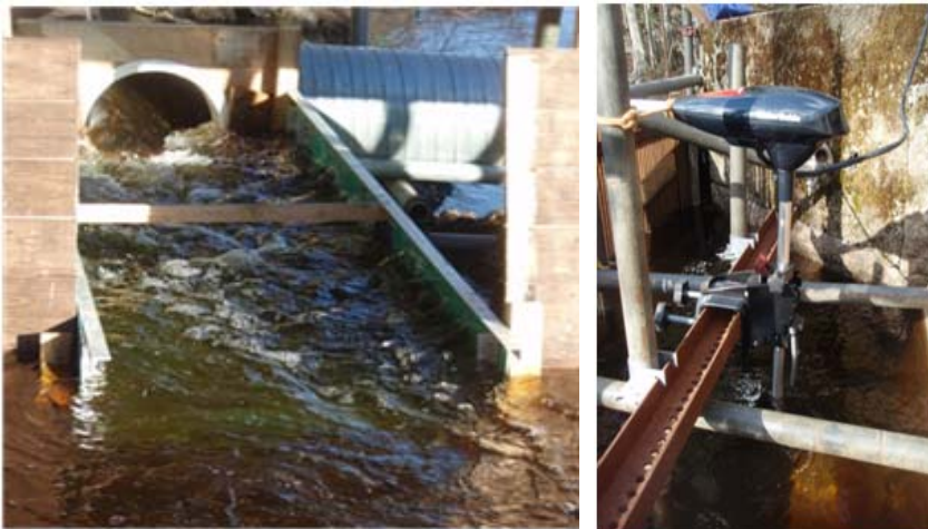
Figur 9 (a) Kraftig inkommande vattenström och (b) elektrisk utombordsmotor använd som pump.
