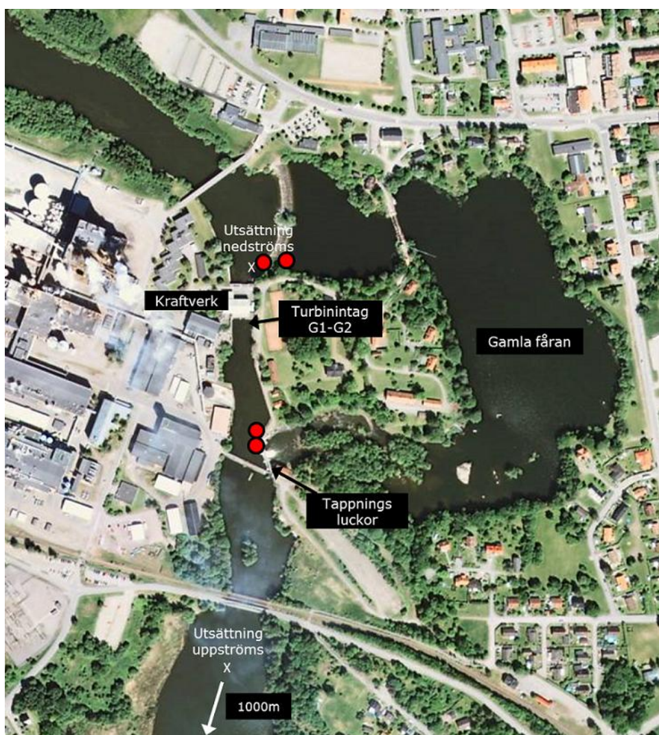
Figur 4. Skärblacka kraftverk med turbinintag, tappningsluckor, den gamla åfåran med avslut i en betongklack samt placeringar av telemetrystationer (röda prickar) och utsättningsplats upp och nedströms kraftverket. Bild modifierad från www.eniro.se .
