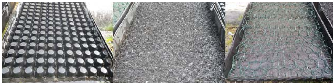
Figur 2. Substraten som användes vid försöken: D-25, Enkamat och Nätrulle.
