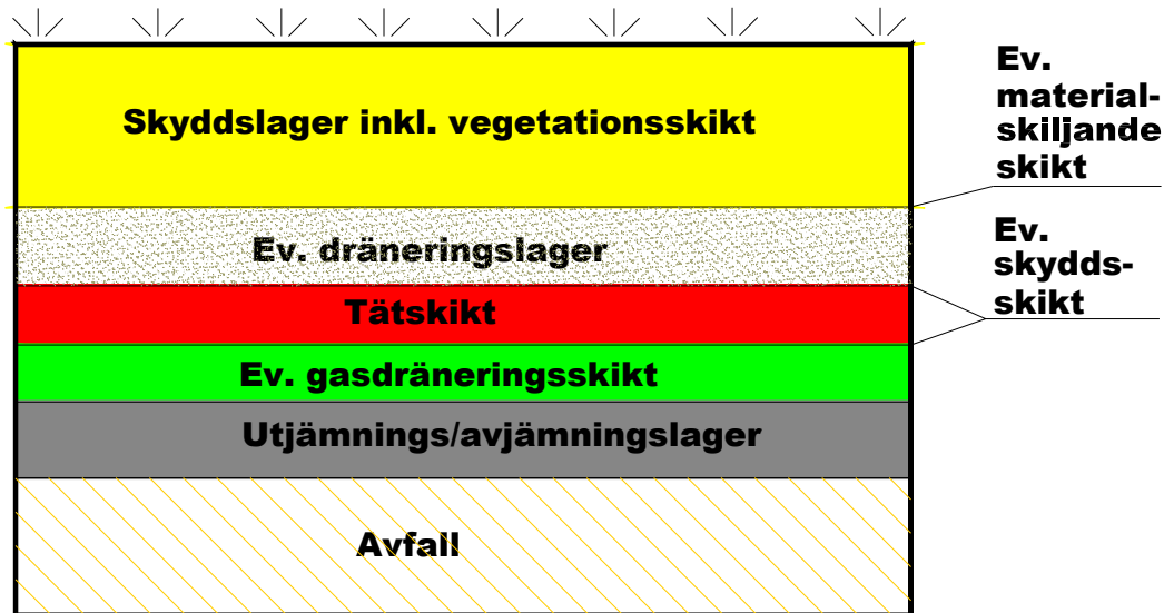
Figur 1.1 Principsektion för sluttäckning av deponi.
