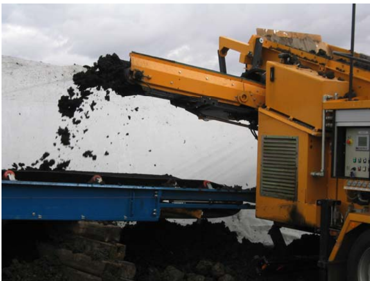
Figur 2. Utmatning av slam från stjärnsikten till transportbandet.
