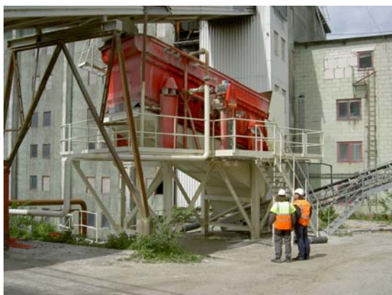
Bild 1. Förtvätt där material mindre än 2 mm tvättas bort.
