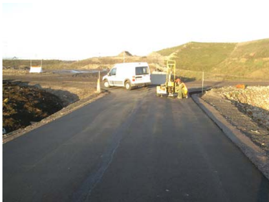
Bild 23. Fallviktsmätning en kylslagen decem-berdag 2006 på nylagd asfalt.
