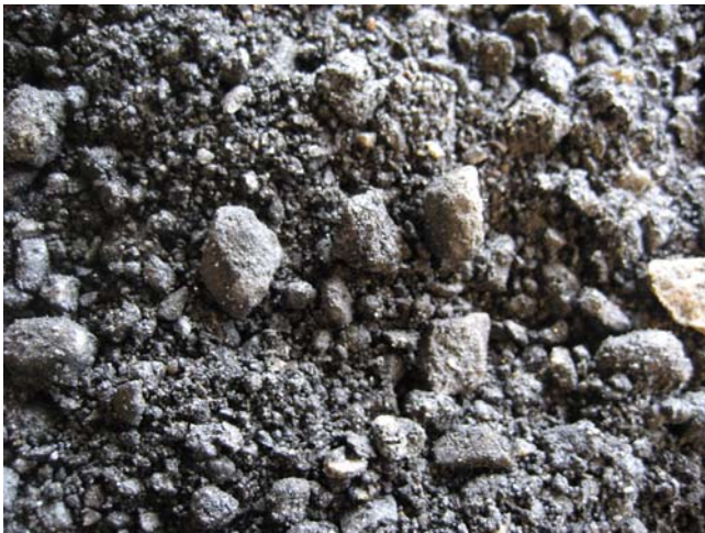
Bild 4. Krossad asfalt tillför SLAGG-produkterna goda egenskaper .
