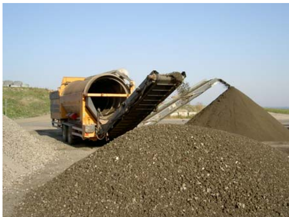
Bild 7. En trumsikt är en lätthanterlig och effektiv utrustning för uppdelning i kornstorlekar.
