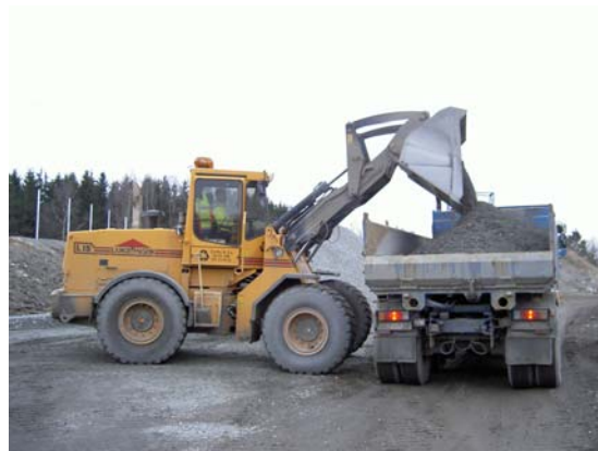
Bild 6. SLAGG-produkterna blandades på plats i Tagene enligt upprättade recept med vågutrustad lastmaskin.
