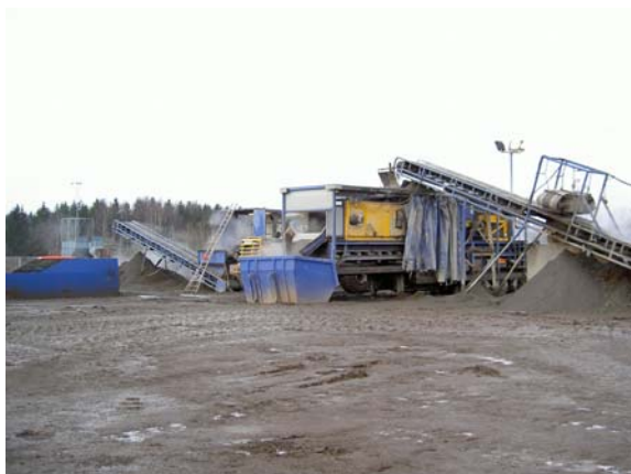
Bild 2. Avskiljning av metall är början på bottenaskans väg till slaggrus.
