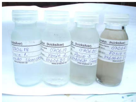
Bild 14. Behållare för metallanalys i vatten. Från vänster: avjoniserat vatten (referens), vatten från SLAGGgrus 2-22,4, SLAGGsand 0,25-2 (något grumligt) och SLAGGsand 0-2 (mycket grumligt).
