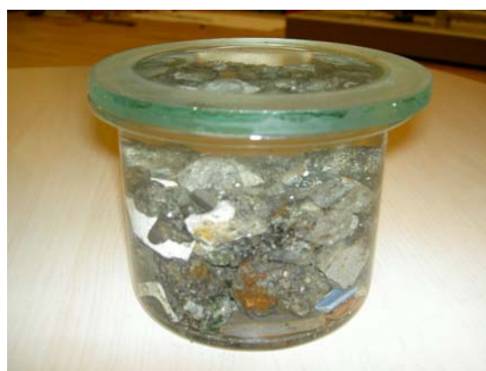
Bild 16. Densiteterna bestämdes i vatten och med pycnometer.
