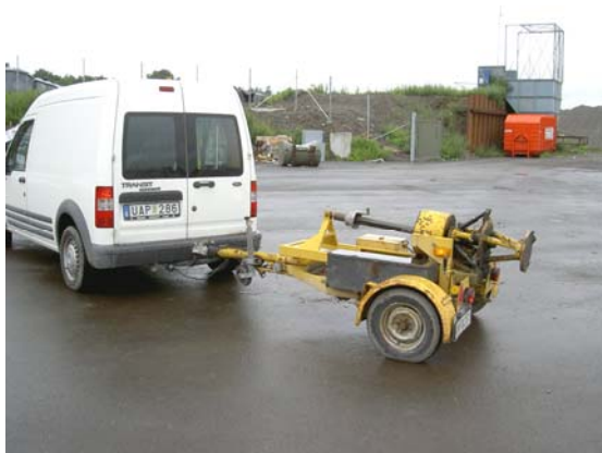
Bild 10. Bärförmågan hos hela konstruktionen mättes med tung fallvikt.
