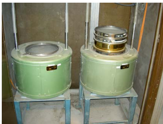
Bild 6. 0-8 mm delades på 2 mm i en skak-sikt. 2-8 mm tillfördes sedan delen 8-22,4 mm.
