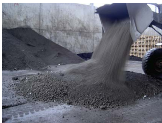
Bild 4. Blandningen gjordes med lastmaskin med vägning i en hall för beredning av bränslen
