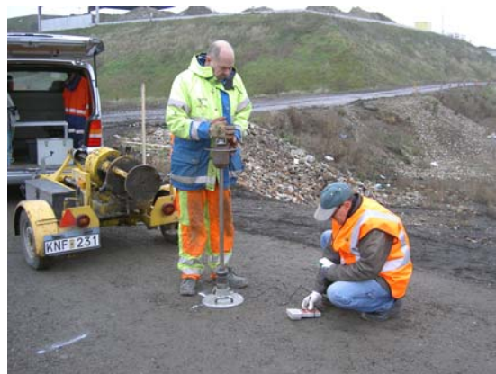
Bild 22. Stabiliteten hos bärlagermaterialen mättes med lätt fallvikt.
