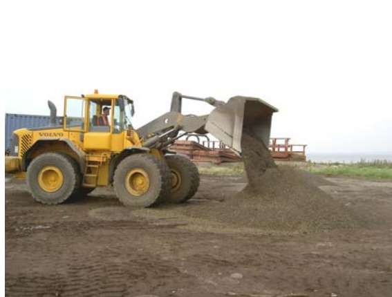
Bild 8. En lastmaskin med vägning är en enkel och säker blandning för små volymer.
