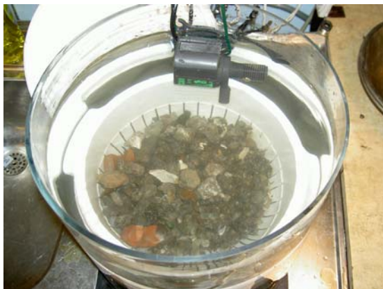
Bild 11. Lakförsök enligt SS-EN 1744-3 med tvättat SLAGGgrus 2-22,4.
