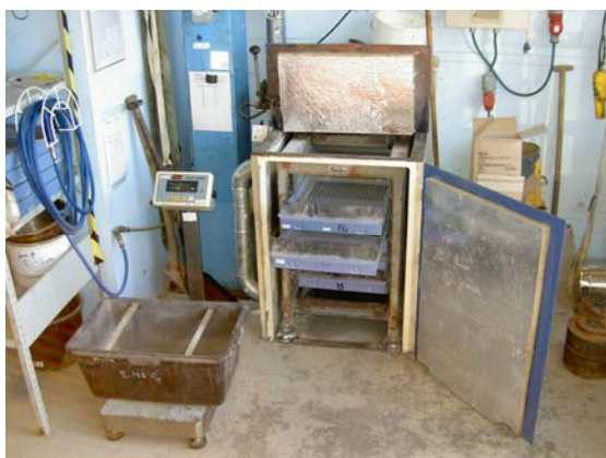
Bild 5. Efter sammanslagning av uttagna prover delades slaggruset upp i 0-8 mm och 8-22,4 mm i en Gilsonsikt.
