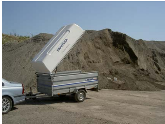
Bild 4. Från mognat och rensiktat slaggrus togs prover ut även från det inre av upplagen.
