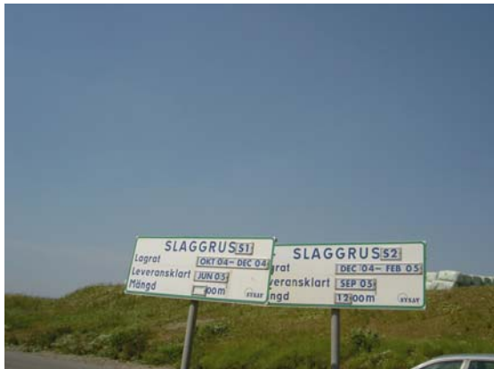
Bild 3. Slaggrus lagras i sex månader innan det används som konstruktionsmaterial.
