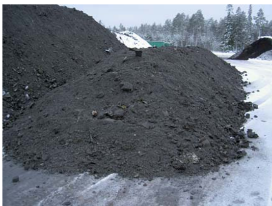
Bild 3. Slaggruset hade mognat och rensiktats innan det blandades med övriga komponenter.
