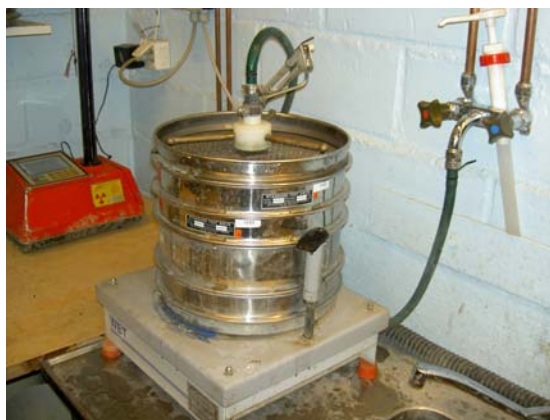
Bild 8. Vatten sprinklades över slaggruset på siktat under vibrering.
