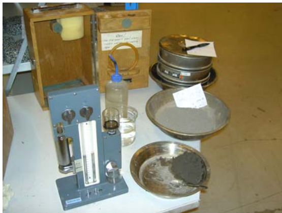
Bild 20. Utrustning typ M/50 för bestämning av kapillaritet.
