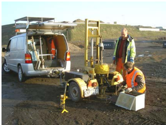
Bild 21. Med tung fallvikt bedömdes bärförmågan hos underlaget.
