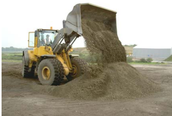
Bild 7. Lastmaskin med våg blandade samman materialen.
