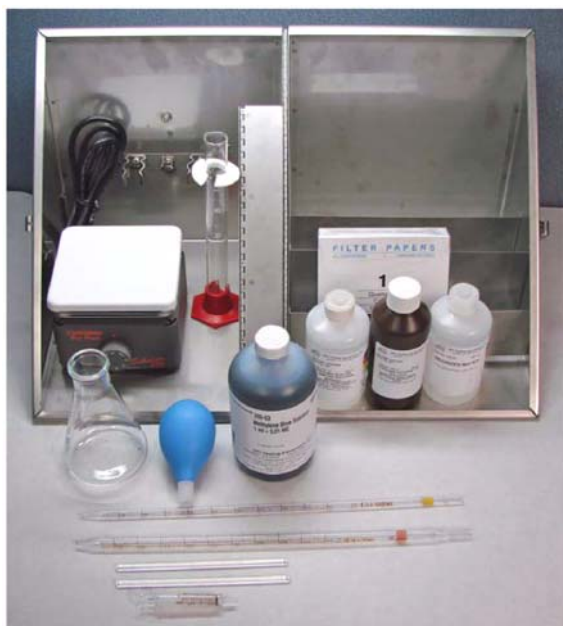
Bild 17. Utrustning för bestämning av metylenblåvärde, MB.
