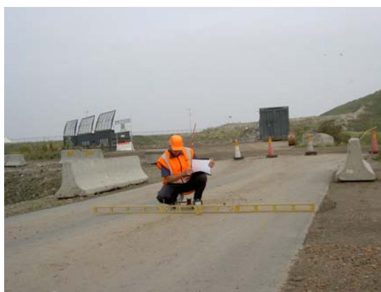
Bild 26. Spårdjupet mättes med en rätskiva.
