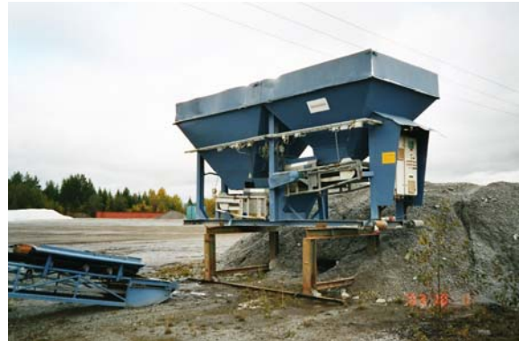
Bild 10. Mobil doseringsutrustning för sammansättning av komponenter.
