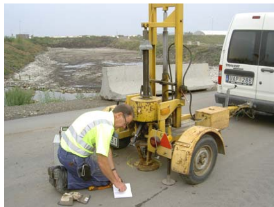
Bild 24. Fallviktsmätning efter 8 månaders tung trafik i augusti 2007.
