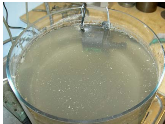
Bild 12. Findelen i SLAGGsand 0-2 grumlar lakvattnet.
