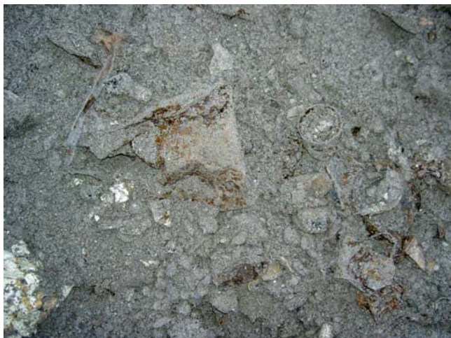
Bild 1. Osorterad rosterbottenaska direkt från förbränningen.
