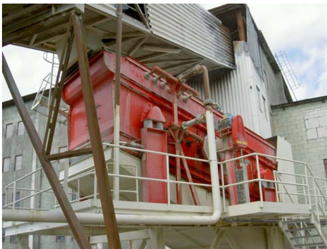
Bild 5. Tvättning är en beprövad och storskalig teknik för borttagning av findelen ur grusmaterial.
