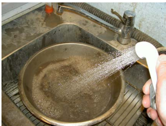
Bild 7. Materialet blöttes och rördes runt innan det hälldes över i en automatisk tvättutrustning.
