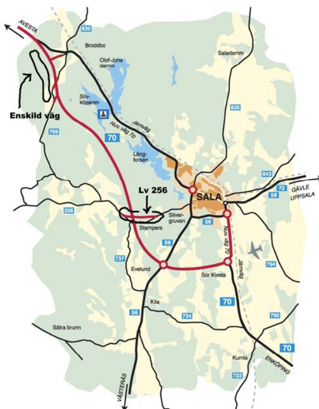
Figur 2.3 Översiktsplan över projekt "Väg 56/70 förbi Sala" med lägen för valda provsträckor benämnda Enskild väg respektive Lv 256.
