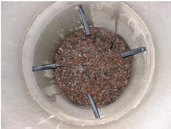
Figur 2-3 Brunn för uppsamling av vatten från lysimetrar och avrinningsytor, Gärstad.
