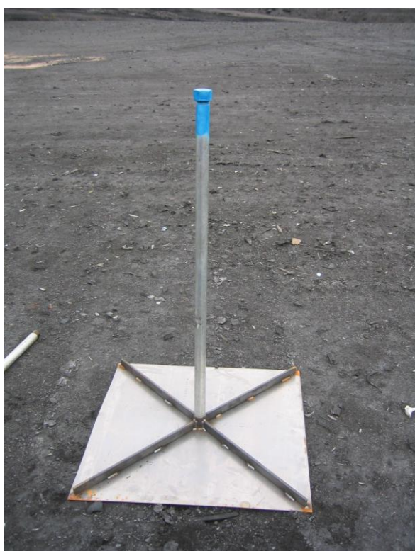
Figur 2-8 Exempel på sättningspegel.
