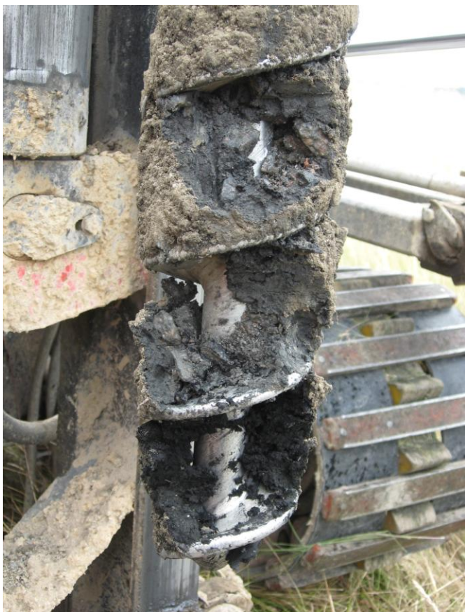
Figur 2-12 Prov från tätskiktet taget med skruvborr, Gärstad juni 2008.
