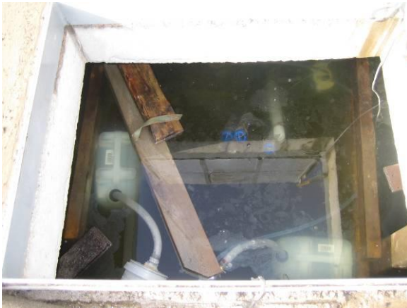
Översvämning i brunn 2 vid asksträcken efter vattning.
