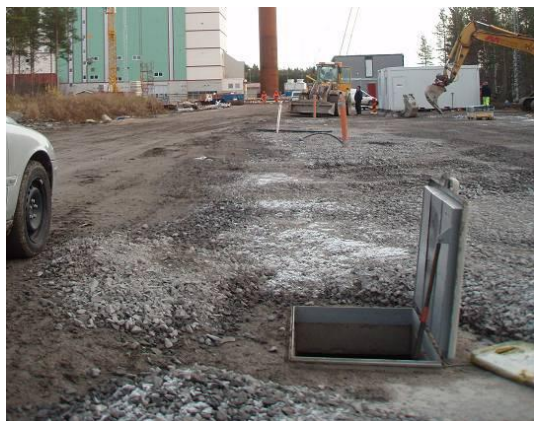
Figur 18. Dåvavägen, asksträckan. Provtagningsbrunn 2 i oktober 2007 och i april 2008.
