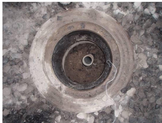
Figur 32. Dåvavägen i oktober 2007. Vänster: Grundvattenrör 1 och 3 som ursprungligen sattes i den södra vägs slänten. Höger: Grundvattenrör 1 är kapat och täckt med ett brunnsluck.
