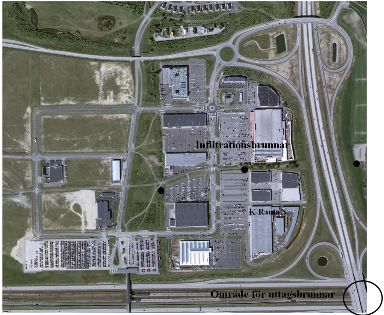
Figur 14. Placering av uttagsbrunnar (vid broläget) och infiltrationsbrunnar (norr om broläget) enligt koordinater redovisade av Lie et al [7].
