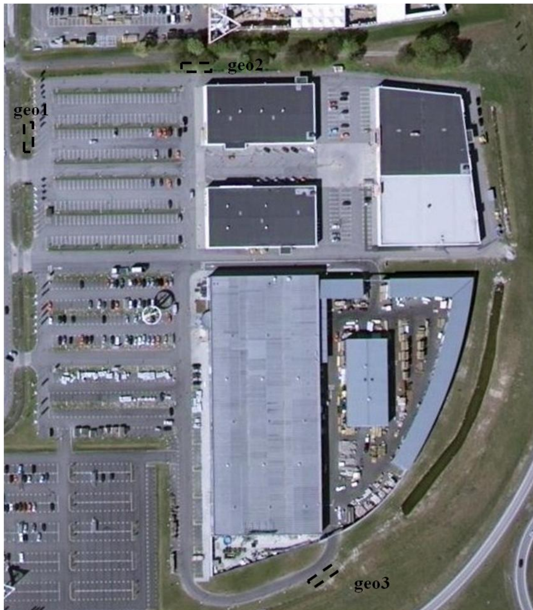
Figur 24. Utförda yttäckande resistivitetsmätningar inom undersökningsområdet (streckade svarta linjer).
