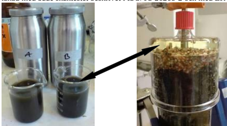
Figur 2E: Samma material, förorenad jord med hög organisk halt, lakad med olika metoder; skaktest med efterföljande centrifugering samt ER-H metoden. Mobiliseringen av partiklar var mycket högre i skaktestet och partiklarna var sedan svåra att avskilja genom centrifugering. Analyserade halter av PAH:er var mycket högre i lakvattnet från skaktestet. Källa: Elert et al., 2008.
