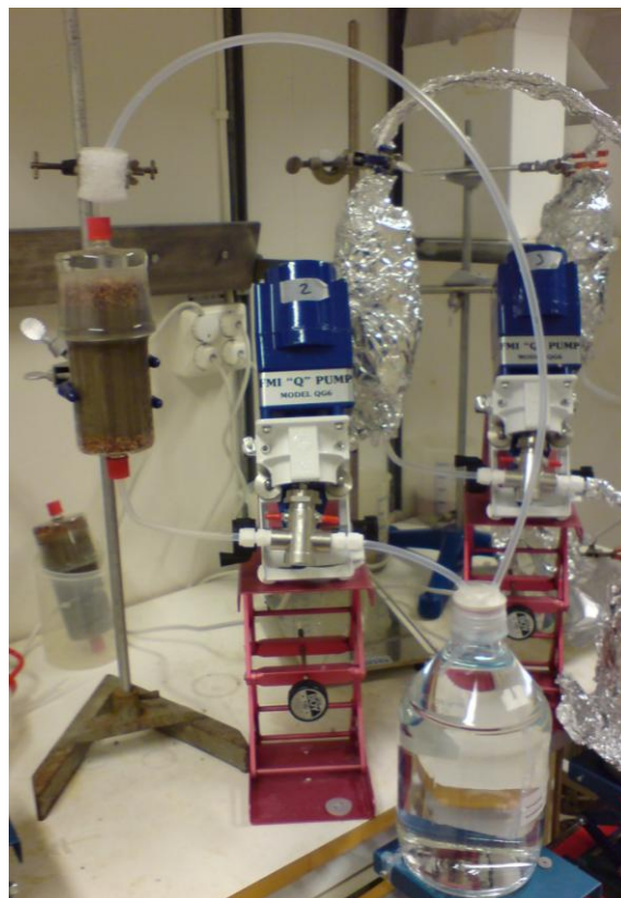
Figur 1. Kolonnlakningstest, ER-H-metoden, för uppskattning av jämviktsfördelningen mellan fast och flytande fas för ickeflyktiga organiska ämnen. Lakvätskan recirkuleras genom kolonnen, från botten till toppen.
