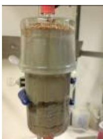
Figur 5E: Delning av materialet vid kolonnlakning med Aska F, flygaska träflis. Efter ompackning med lufttorkat material (packades lösare) kunde däremot kolonntest utföras.
