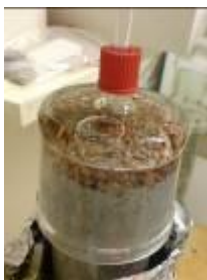
Figur 4E: Liten gasutveckling från Aska B, stabiliserad flygaska.
