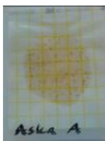
Figure 3E: Petrifilm AC odlingsplatta efter inkubation med lakvatten från Aska A, slaggrus. Röda kolonier indikerar förekomst av mikrobiell aktivitet i lakvattnet.
