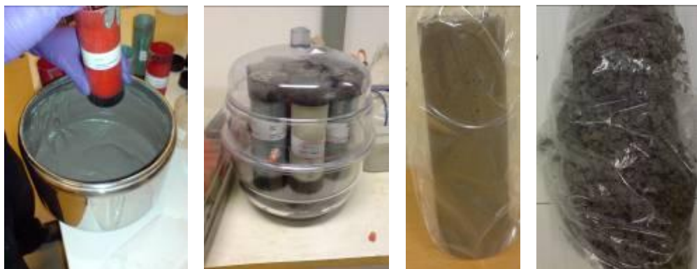
Figur 1F: Flygaska blandades med vatten i degblandare och lagrades sedan i syradiskade behållare. Askan blev monolitisk under lagringen och krossades med hammare innan lakning. Vissa delprover lagrades ytterligare efter krossning, innan lakning.
