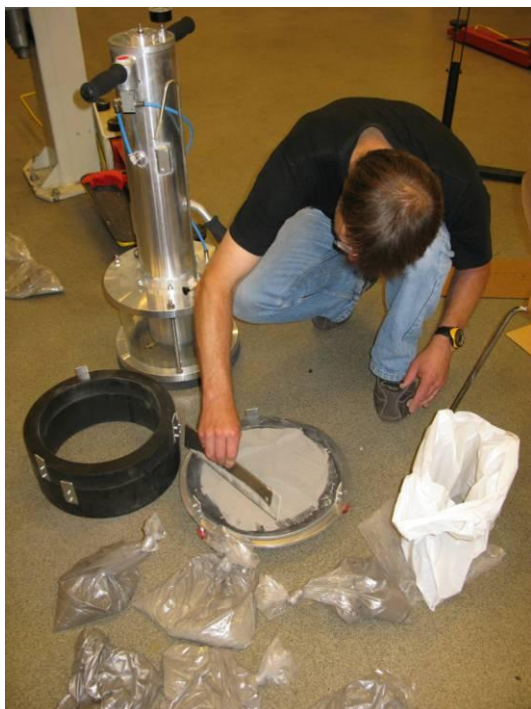
Figur 1. Beredning av askprov i behållare (tv) och provning (th).
