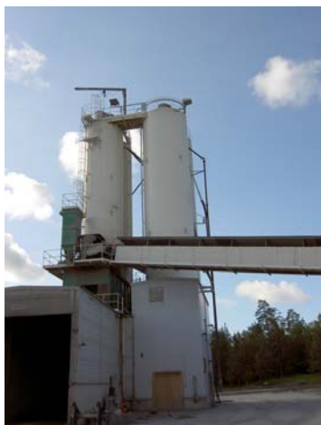
Figur 3. Blandaren på Högbytorp samt silo. Användes för IH och HH askorna.
