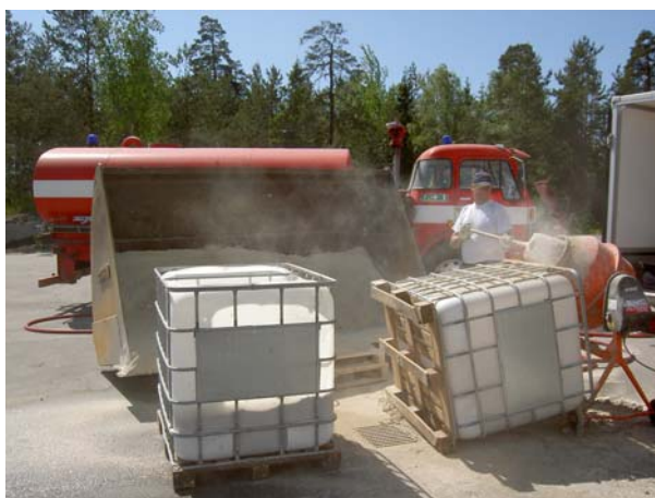
Figur 4. BB-askorna blandas manuellt i betongblandare. Brandvatten (kommunalt kranvatten) användes.
