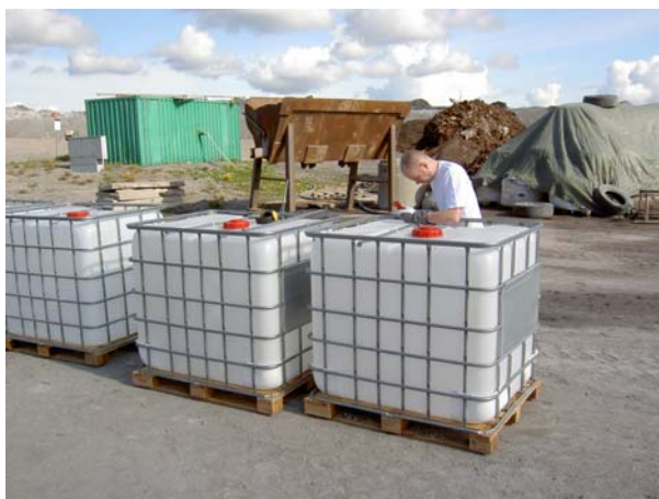
Figur 5. Uppsågade 1000 liter (IBC) användes som försöksbehållare. 6 st gjordes i ordning.
