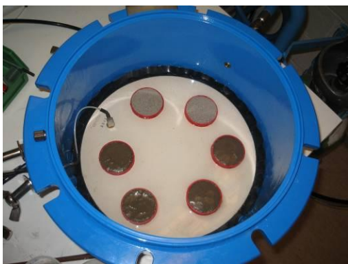
Figur 6. Vattenmättnad av prover i 150 m vp extraktorn.
