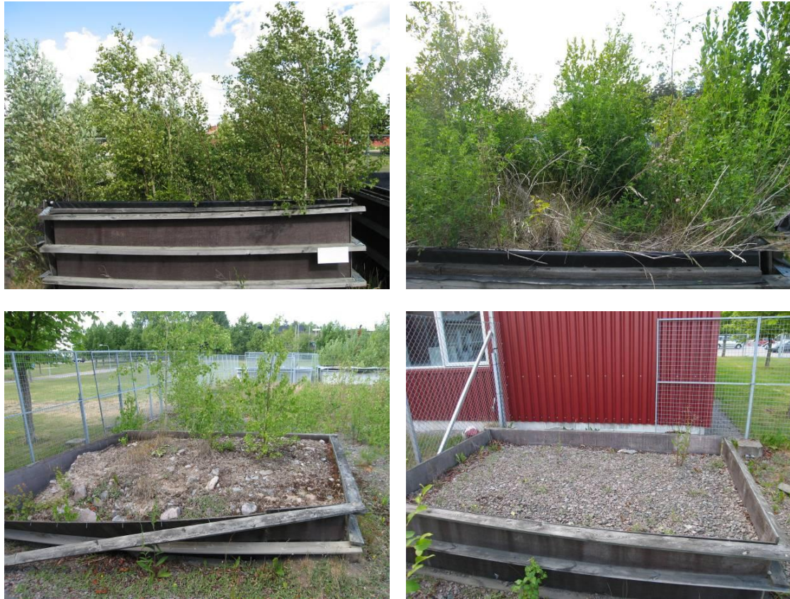
Figur 1. Etablering av vegetation i några av SGI:s lysimetrar. Längst upp till vänster: Björk och Salix i SGI:s lysimeter med vedaska. Längst upp till höger: Sötväppling i SGI:s lysimeter med vedaska. Längst ner till vänster: Björk i SGI:s lysimeter med morän. Längst ner till höger: SGI:s lysimeter med bergkross. Bilderna är tagna i juni 2008.
